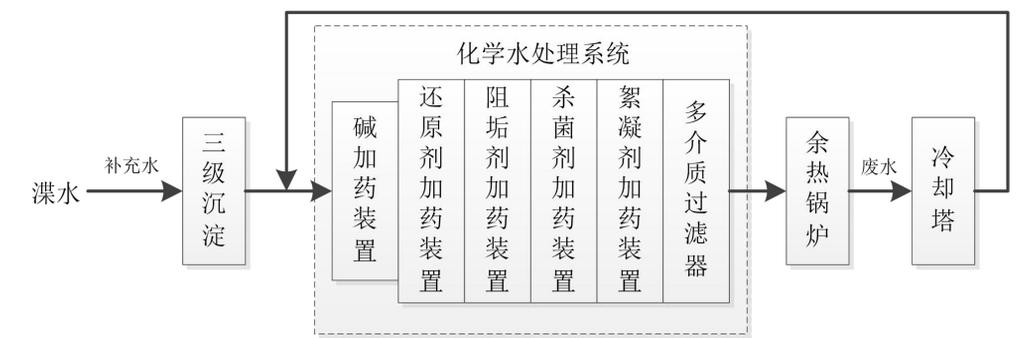
图 3-5-2 项目余热锅炉废水处理工艺流程图
